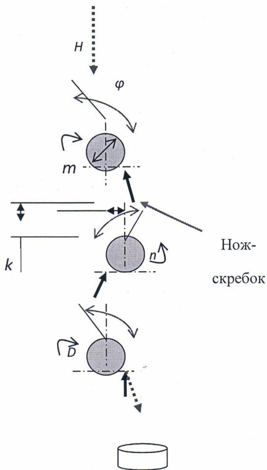
Рис.1 – К схеме слива расплава в установки грануляции
